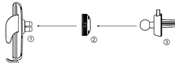
Coloque a porca plástica (2) na esfera de rotação (3). A esfera de rotação é, então, encaixada na abertura de rotação presente na parte de trás do carregador (1). Aperte a porca plástica e ajuste a pressão de acordo com a necessidade de rotação.
