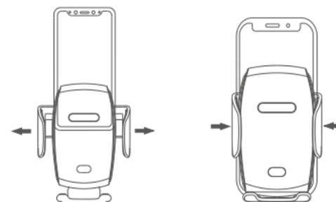
Abertura automática por sensor infravermelho
